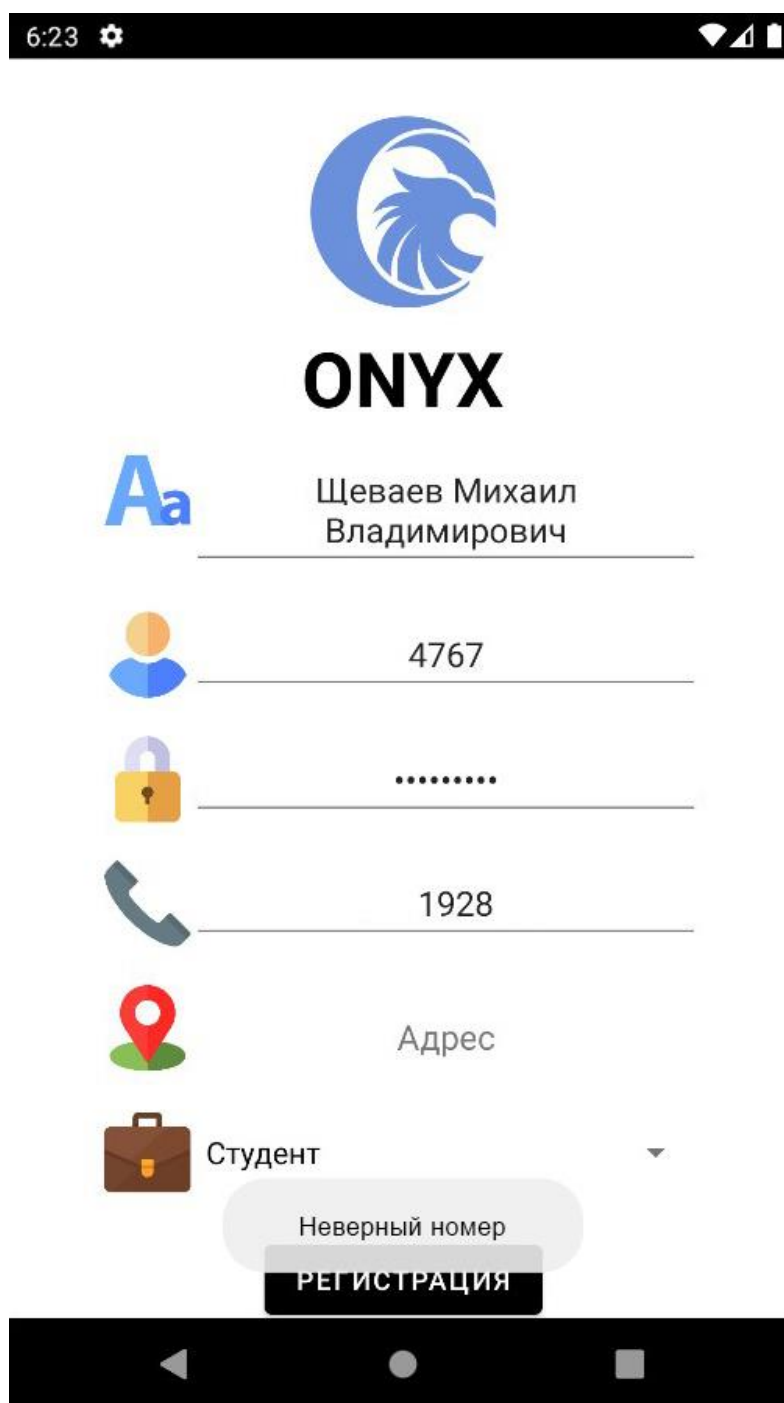
Рисунок Г.4 – Результат функционального тестирования «Ввод некорректного номера телефона»
