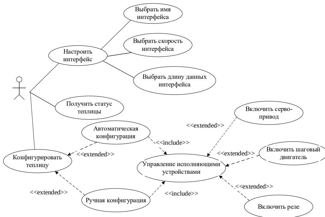
Рисунок 4 – Диаграмма вариантов использования программно-аппаратного комплекса автоматизированной теплицы
