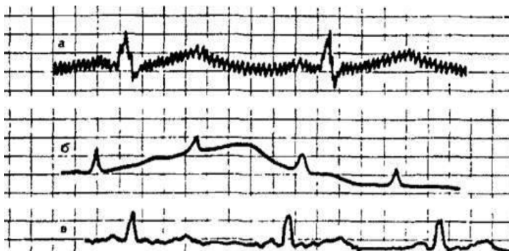
Рисунок 2.13 – Виды помех на ЭКГ (а – вид помех, связанный с работой электроприборов поблизости; б – вид помех, обусловленный плохим контактом электрода с кожей; в – вид помех, связанный с усталостью мышц или гипергидрозом)
