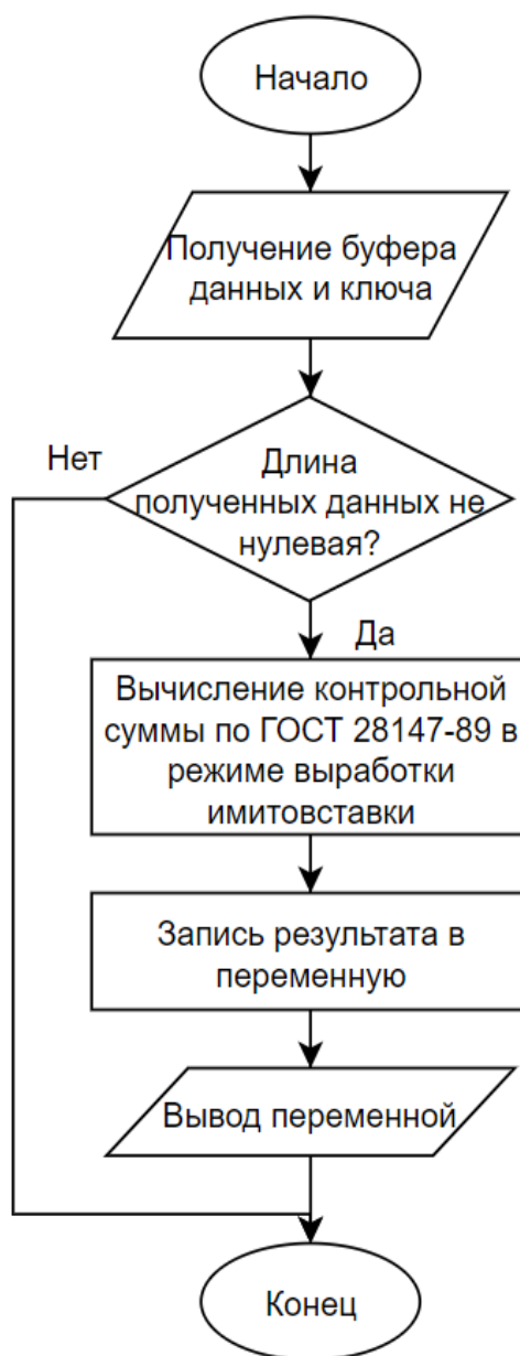
Рисунок 11 — Алгоритм функции вычисления хеш-суммы «passwordhash»
