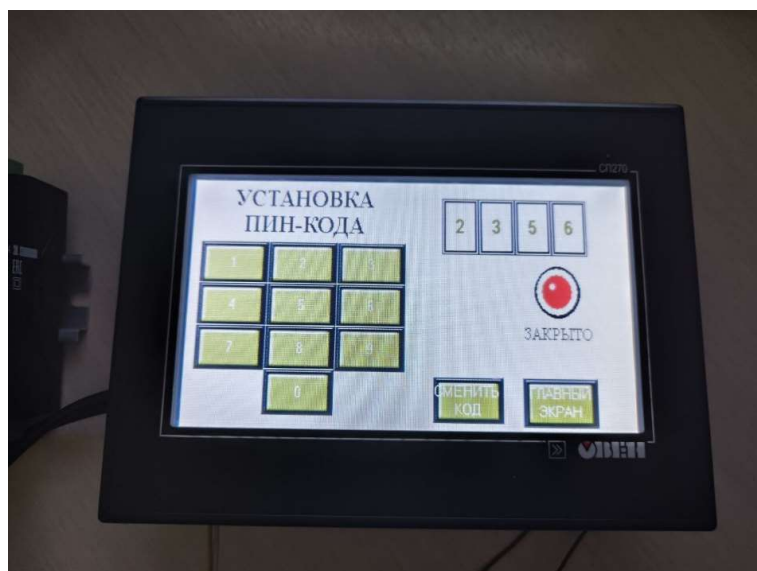
Рисунок 109 – Экран установки кода доступа на панели оператора
