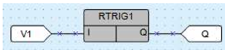
Рисунок 39 – Пример использования функционального блока RTRIG
