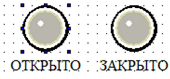
Рисунок 90 – Элементы индикации состояния «Открыто/закрыто» на экране панели оператора
