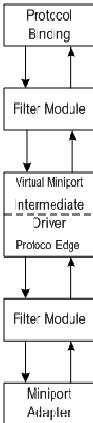
Рисунок 4 – Пример стека NDIS драйверов
