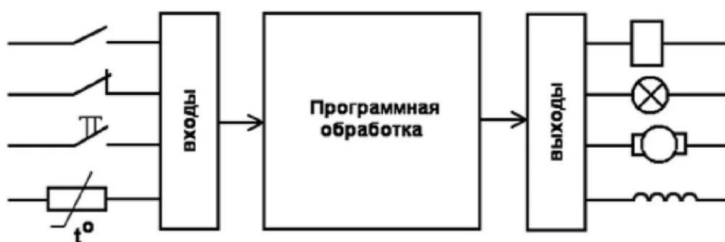
Рисунок 2 - Схема выполнения программы на ПЛК
