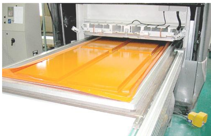
Рисунок 2.10 Облицовка фасадов ПВХ пленкой.
