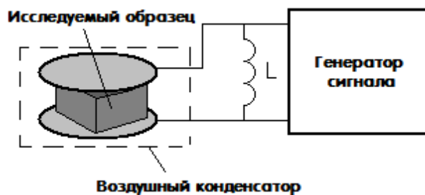
Рисунок 1.8 – Конструкция емкостного датчика влажности
