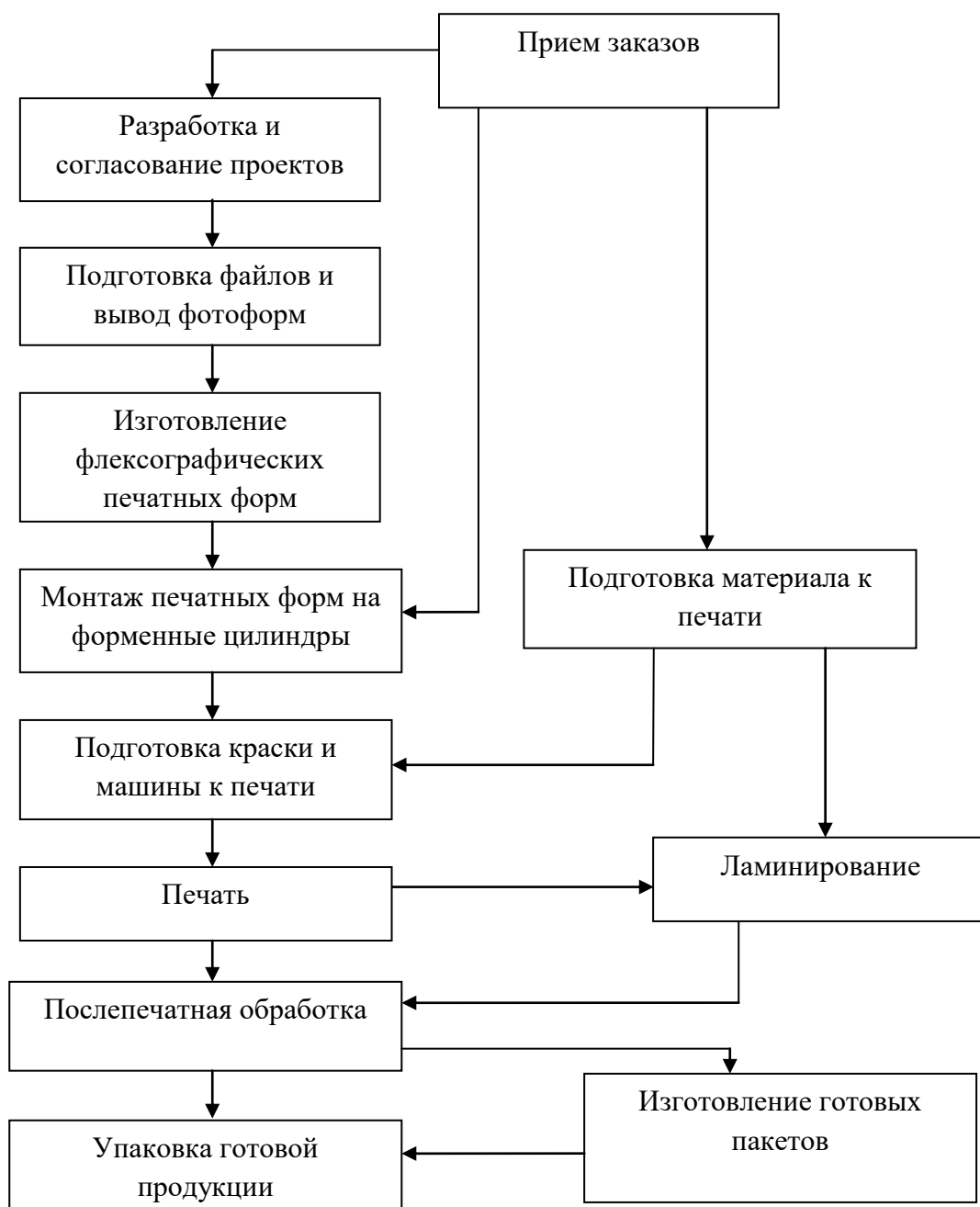
Рисунок 8 – Технологическая схема производственного процесса по выпуску гибкой упаковки
