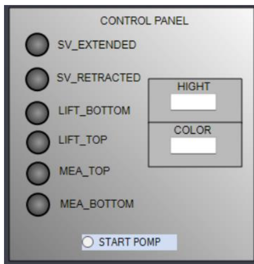
Рисунок 50 – Визуальное представление человеко-машинного интерфейса (блок VIEW )
