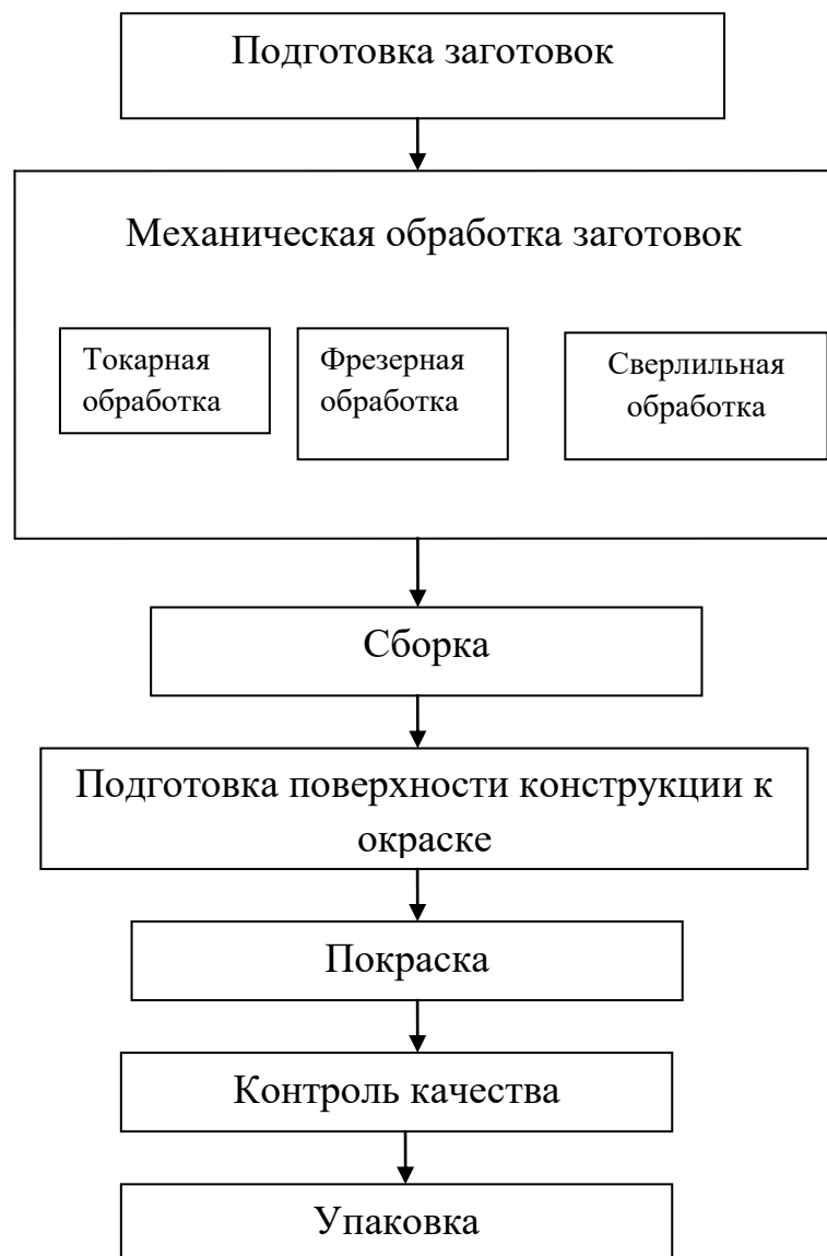
Рисунок 2.4 – Укрупненная технологическая схема производства печей для бань
