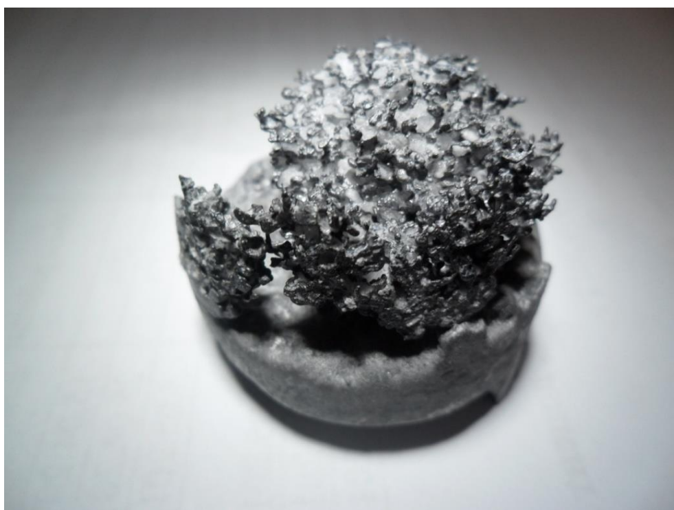
Рисунок 15 – Дефект непропитка (коэффициент гравитации K = 167 )
