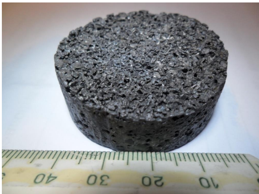
Рисунок 17 – Опытный образец с полной пропиткой без механической обработки
