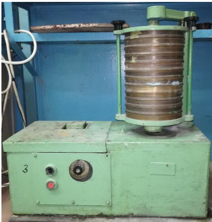
Рисунок 13 – Прибор для определения зернового состава сыпучих материалов модели 029М
