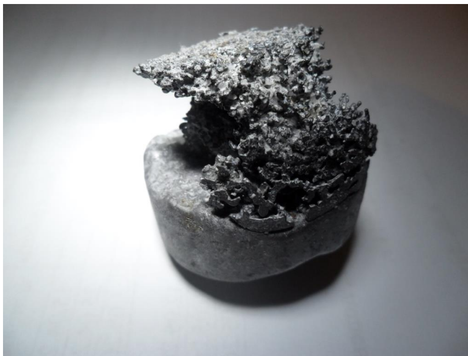
Рисунок 19 – Дефект непропитка (нагрев наполнителя 520 °С)
