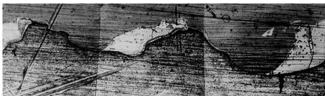
Рисунок 2.5 – Микроструктура зоны соединения медно-алюминиевого композита представлено на рисунке 2.3, зона 4 ( \times 200 )
