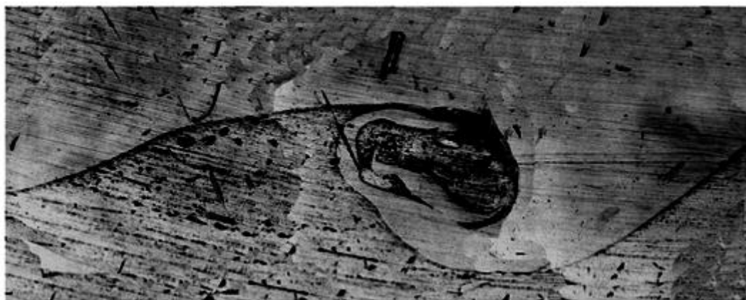
Рисунок 2.4 – Микроструктура зоны соединения медно-алюминиевого композита представлено на рисунке 2.3, зона 3 ( \times 200 )
