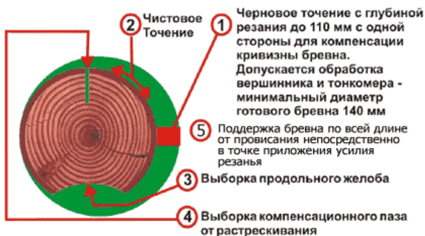
Рисунок 2.5 – Этапы обработки бревна
