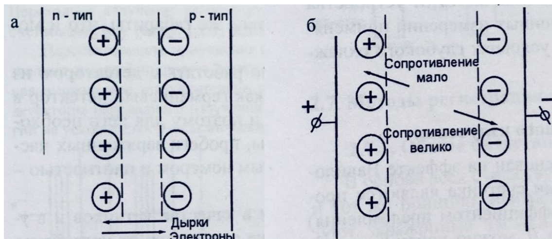
Рис. 5. Схема двойного заряженного переходного слоя (p-n)-перехода а - до подачи внешнего напряжения; б-после включения обратного напряжения.
