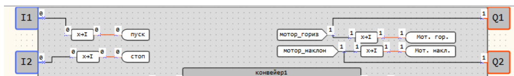
Рисунок 78 – Запуск горизонтальной ленты спустя 10 секунд
