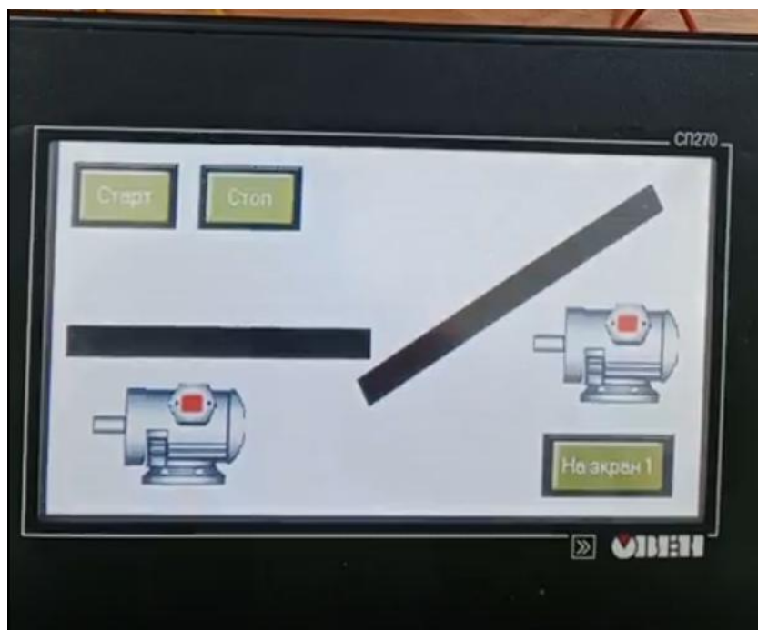
Рисунок 105 – Отключение второго двигателя после нажатия кнопки СТОП
