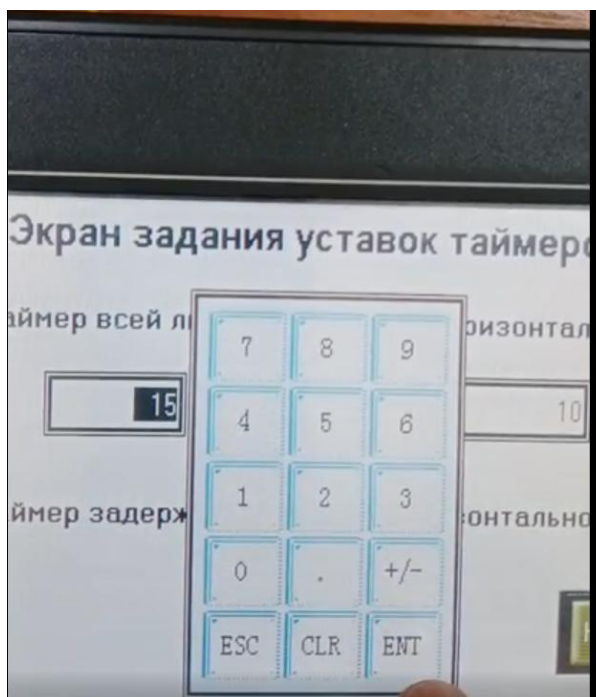
Рисунок 92 – Меню с указанием числа для таймера всей линии
