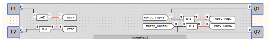
Рисунок 85 – Остановка конвейерной линии из двух лент
