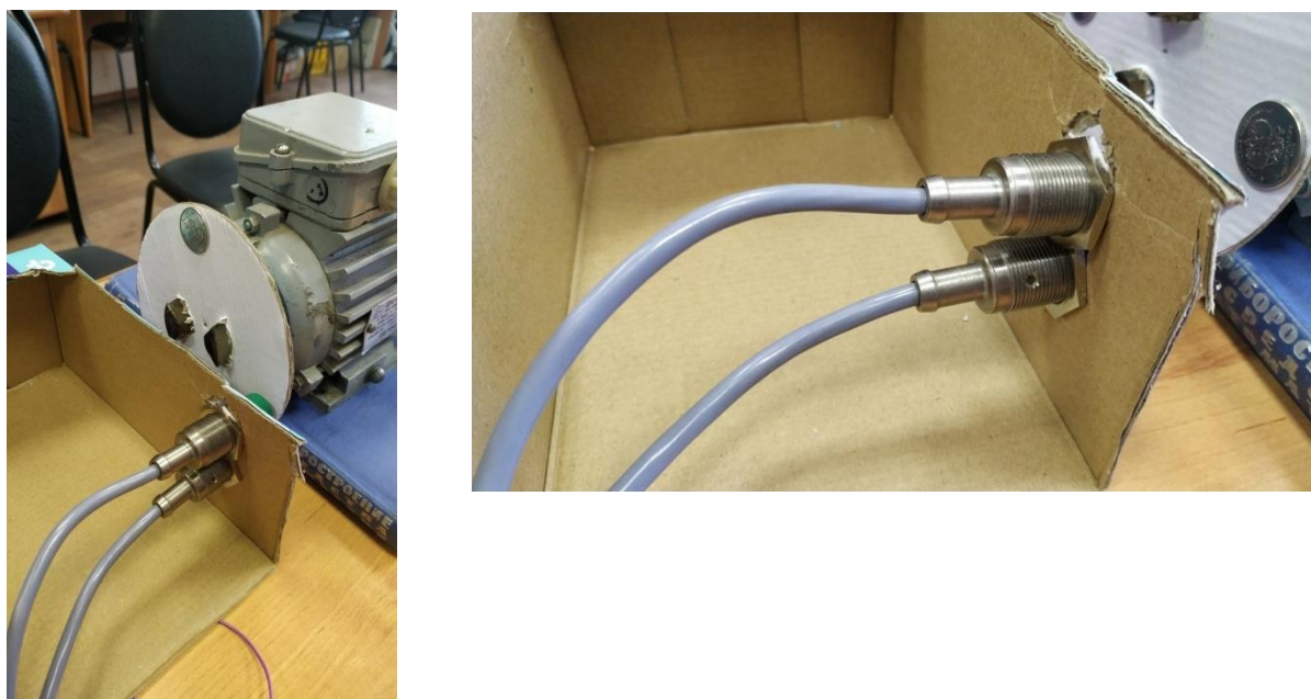
Рисунок 24 — Энкодер с индуктивными датчиками
