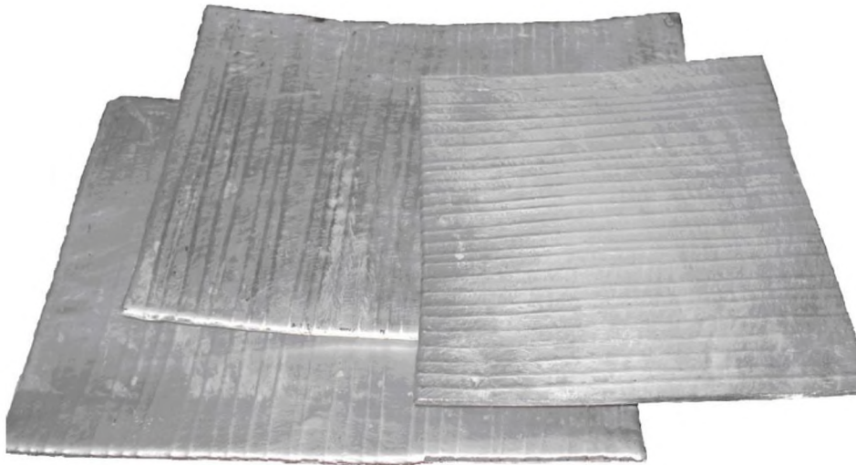
Рисунок 14 – Листовой полуфабрикат армированного композиционного материала на основе АМг5М
