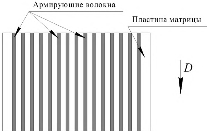
Рисунок 6 – Схематичное расположение волокон (вид сверху): D – направление распространения фронта детонационной волны показано стрелкой
