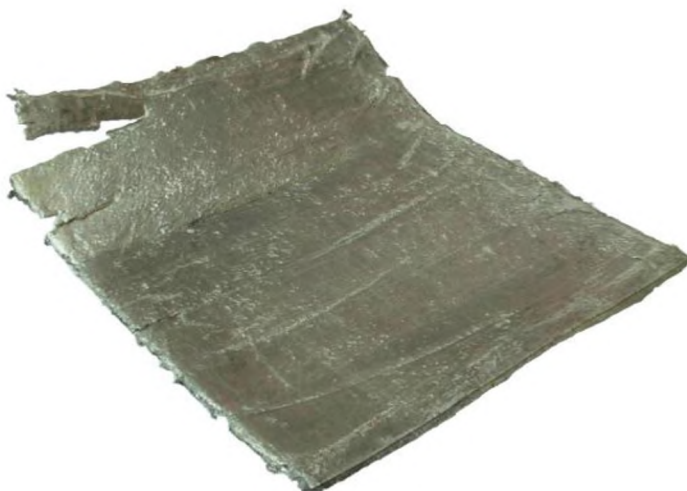
Рисунок 13 – Разрушение образца при сварке взрывом на форсированных режимах
