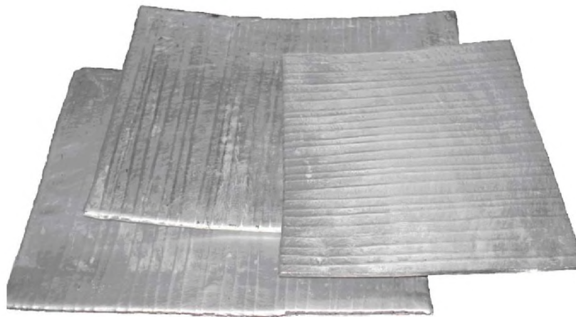
Внешний вид армированного композиционного материала с матрицей из сплава АМг5М, полученного на рациональных режимах
