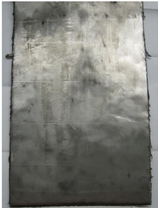
Рисунок 15 – Листовой полуфабрикат армированного композиционного материала на основе ВТ1-0
