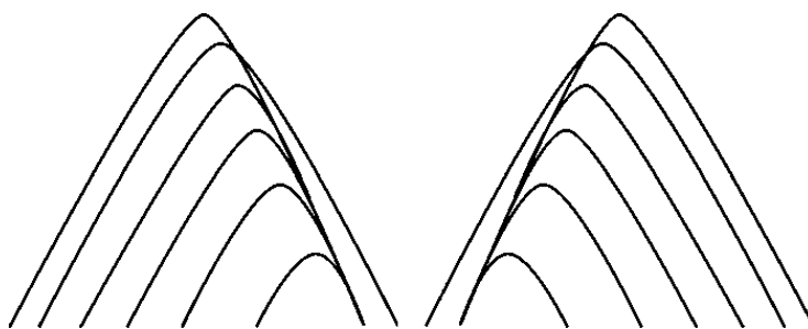
Рисунок – 8. Формообразование резьбовой поверхности при снижении подачи на глубину, но с формообразованием одной из сторон профиля по генераторной схеме
