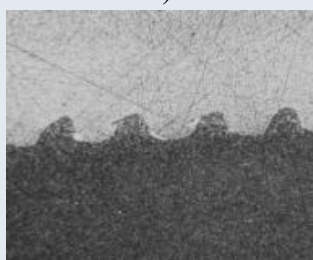
Рисунок 13 – микроструктура образцов после сварки взрывом:
