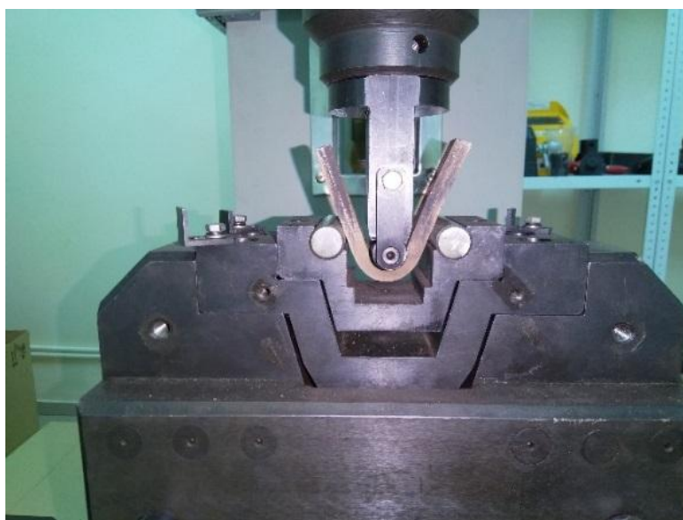
Рисунок 32 – Экспериментальный образец композиционного металлического материала после проведения испытаний на статический изгиб
