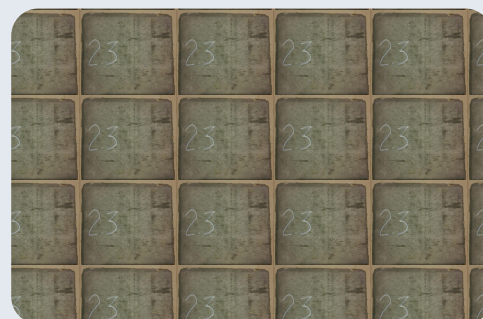
Рисунок 3 – внешний вид полученного композиционного материала на рациональных параметрах ударно-волнового нагружения
