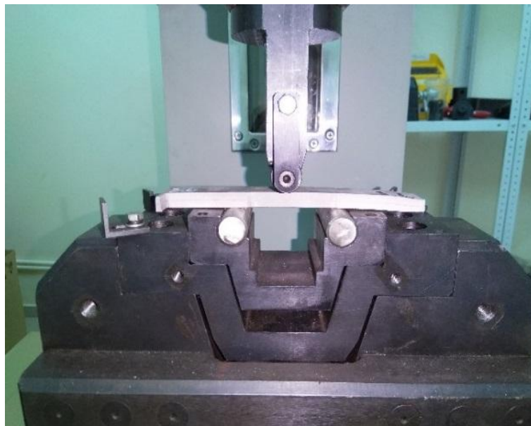
Рисунок 31 – Экспериментальный образец композиционного металлического материала до проведения испытаний на статический изгиб
