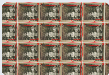
Рисунок 2 – внешний вид полученного композиционного материала на нерациональных параметрах ударно-волнового нагружения
