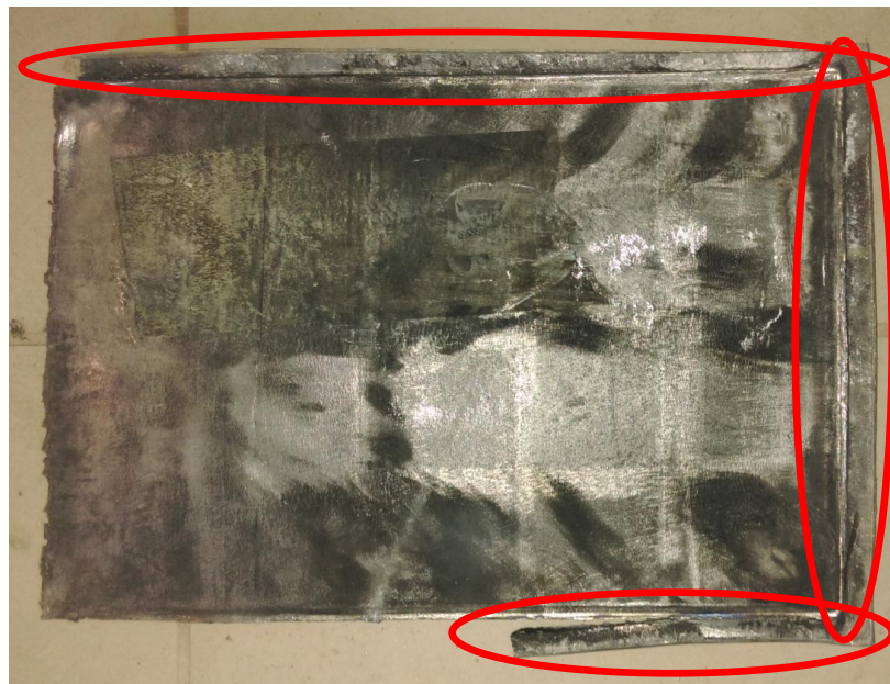
Рисунок 14 – Композиционный материал при сварке на нерациональных режимах два и три, на котором красным цветом выделены участки неполной обрубки металла по краям композита
