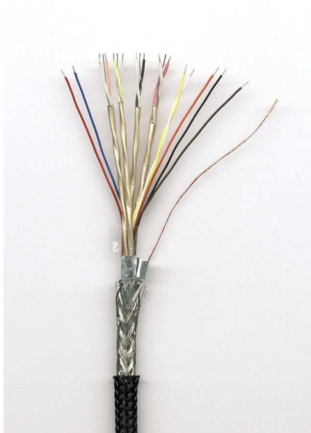
Рисунок 2 – Конструкция кабеля HDMI
