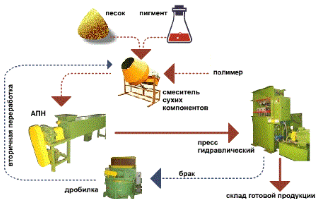
Рисунок 2.11– Процесс производства полимерпесчаной продукции
