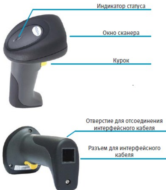
Рисунок 12 - Внешний вид сканера «ICS-7199»
