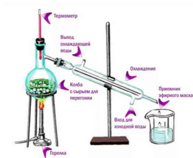
Рисунок 1. Схема сборки установки для получения эфирного масла сосны обыкновенной путем перегонки
