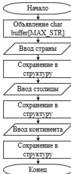
Рисунок 9 - Блок-схема функции input_record
