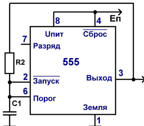
Рисунок 2.26 – Генератор меандра на КМОП версиях таймера 555
