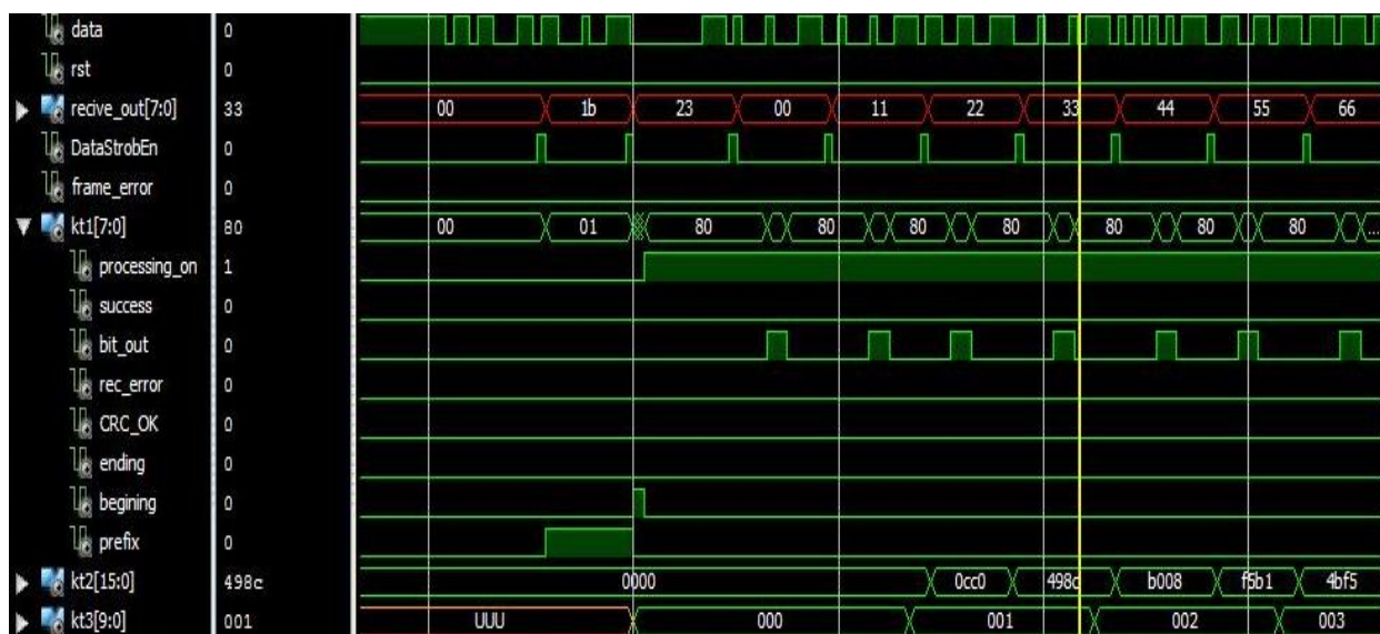
Рисунок 22 – Проверка работоспособности узла обработки в начале пакета
