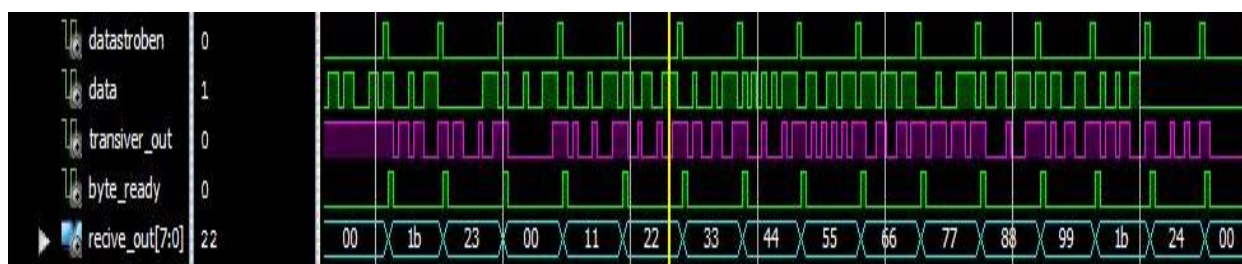
Рисунок 21 – Проверка работоспособности узла передачи
