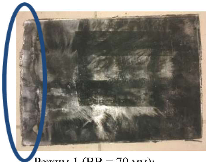
Режим 1 (BV = 70 мм); дефекты (деформация, оплавление)
