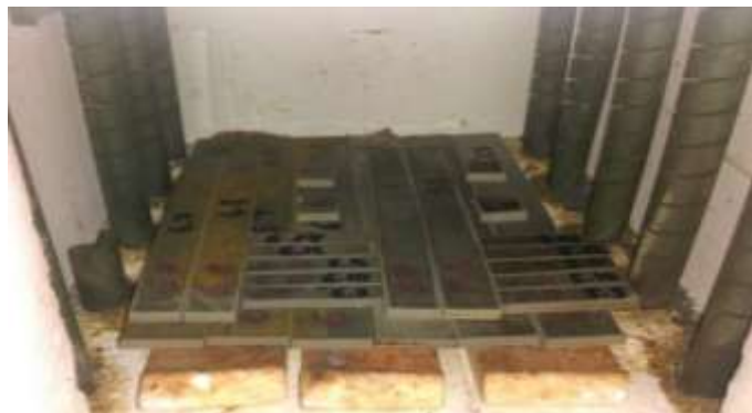
Рисунок 24 - Укладка образцов многослойных композиционных материалов в печь перед термической обработкой
