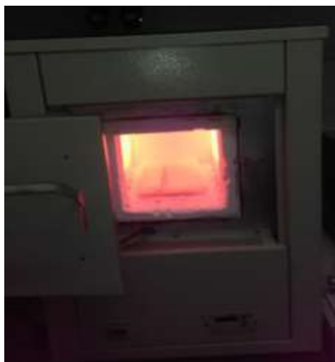
Процесс ТО (нагрев под закалку) образцов в муфельной печи
