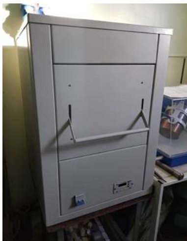
Общий вид муфельной печи
