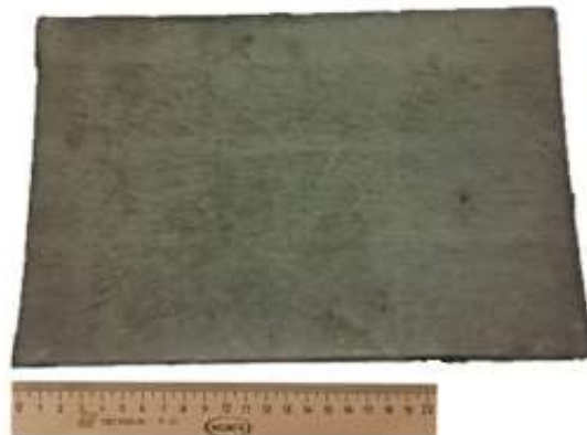
Рисунок 21 - Листовой полуфабрикат композиционного материала (без дефектов) при сварке на режиме 2 (60 мм)
