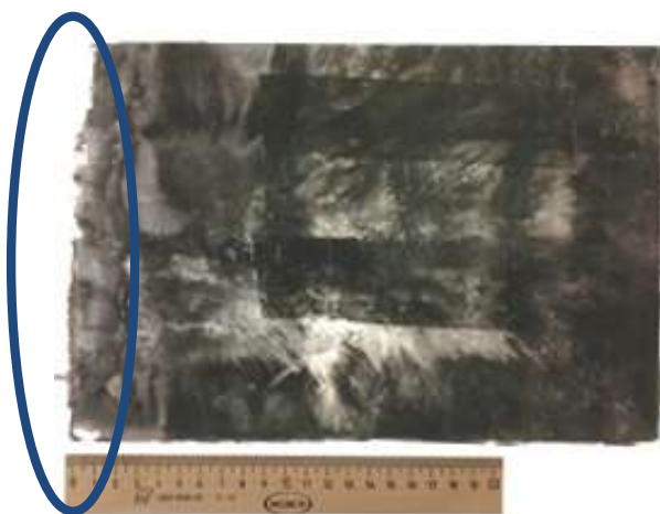
Рисунок 20 - Дефекты (деформация) композиционного материала при сварке на режиме 1 (70 мм)
