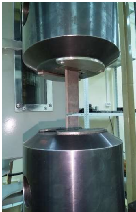
Испытания на одноосное растяжение экспериментальных образцов КМ (ГОСТ 1497-84)
