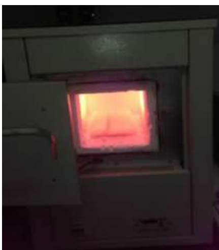
Рисунок 25 - Нагрев под закалку многослойных композиционных материалов
