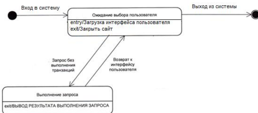
Рисунок 1.3 – Диаграмма состояний (обобщенное функционирование)
