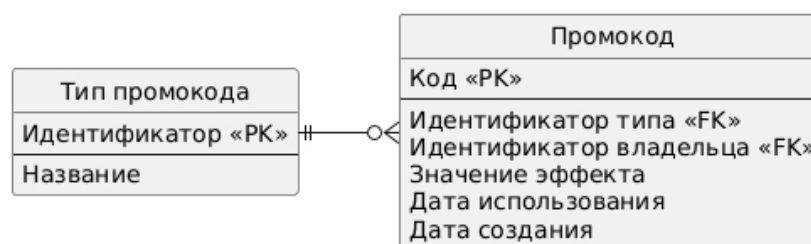
Рисунок 20 – Логическая модель базы данных промокодов
