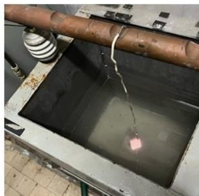
Электролитическая ванна с водяным охлаждением для эксперимента.
