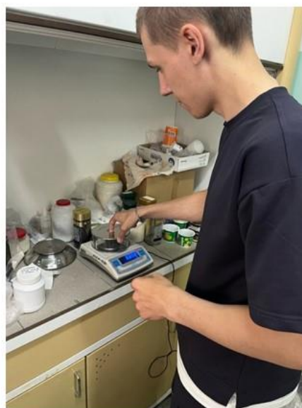
Взвешивание экспериментальных образцов КМ на измерительных весах BM510Д
