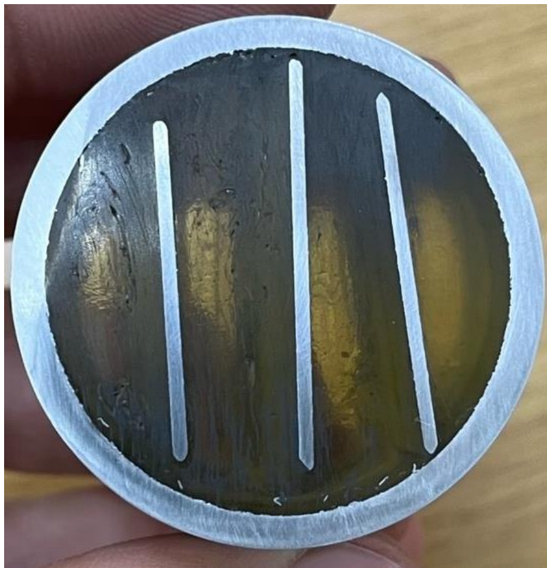
Рисунок 3.2 - Микрошлифы композиционных металлокерамических материалов на основе сплава АД1, полученных МДО
