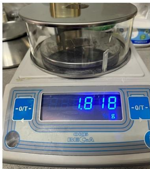
Взвешивание экспериментальных образцов КМ на измерительных весах BM510Д
