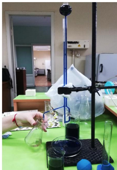
Рисунок 14, 15. Определение содержания яблочной кислоты
