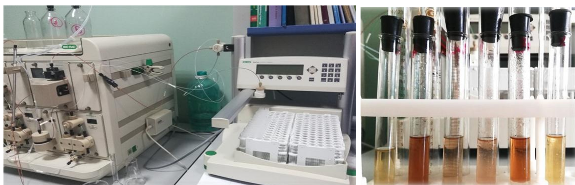
Рисунок 18, 19. Выделение сердечных гликозидов (фотоколориметр и экстракты боярышников)
