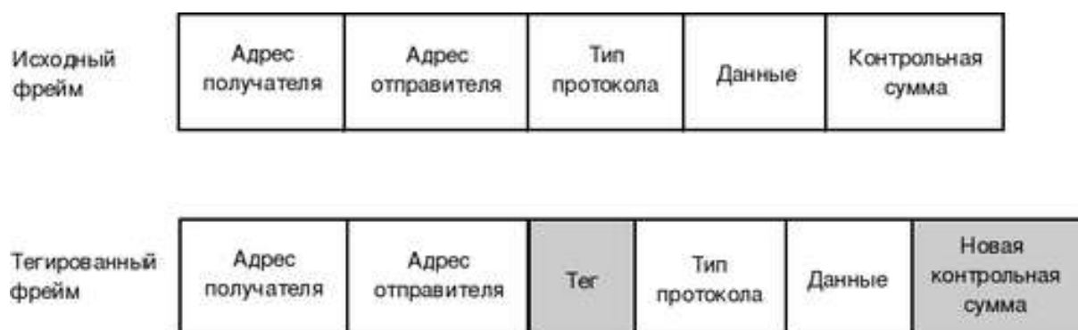
Рисунок 6 - Формат кадра Ethernet с добавлением тега
