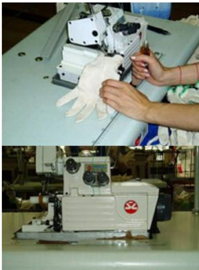
Рисунок 2.5 - Перчаточный оверлок SALUT-02
