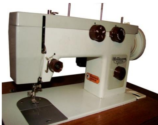
Рисунок 2.9 - Швейная машина для пошива рукавиц
