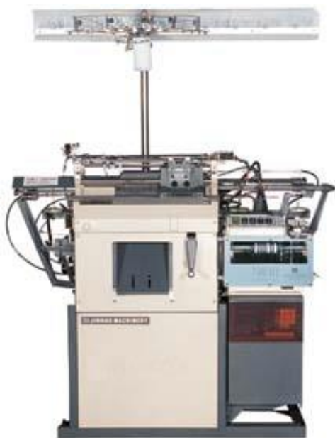
Рисунок 2.2 - Полностью автоматический станок для вязки перчаток с электронным управлением — GD—D
