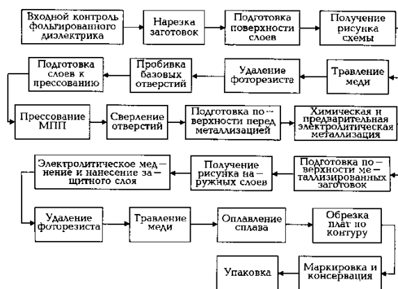
Рисунок 2.3 – Схема типового технологического процесса изготовления МПП методом металлизации сквозных отверстий
