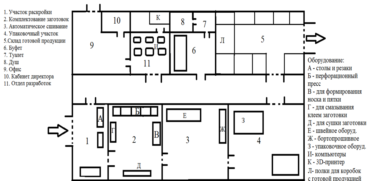
Рисунок 2.11– План производственного помещения с оборудованием
