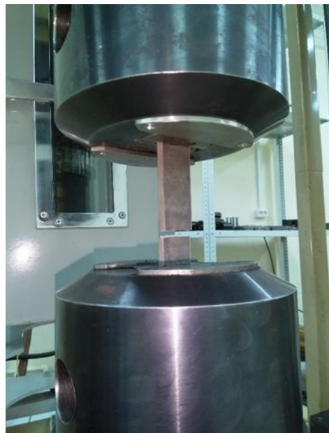
Испытания на одноосное растяжение экспериментальных образцов КМ (ГОСТ 1497-84)
