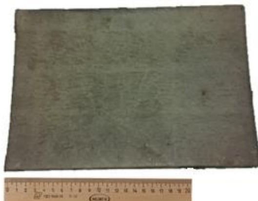
Рисунок 4.2. – Листовой полуфабрикат композиционного материала (без дефектов) при сварке на режиме 2 (60 мм)
