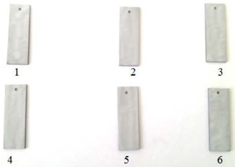
Рисунок 17 – Образцы с покрытием ГДН от 90 до 100 мкм, по порядку с 1 по 6
