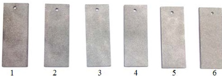
Рисунок 16 – Образцы из стали Ст.3 после струйно-абразивной обработки, по порядку с 1 по 6
