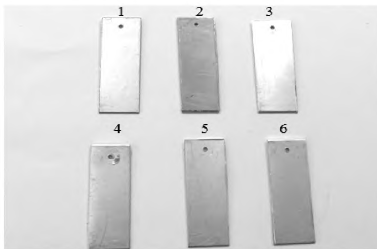
Рисунок 19 – Образцы для отработки режимов МДО из алюминия марки А7, по порядку с 1 по 6
