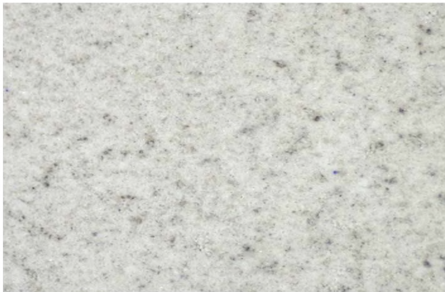
Рисунок 25 – Макроструктура поверхности образцов с покрытием от 75 до 80 мкм
