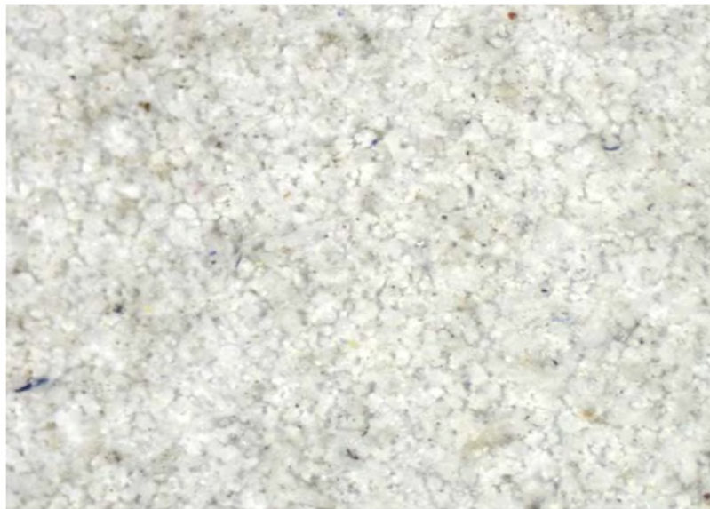
Рисунок 21 – макроструктура поверхности образцов с покрытием от 90 до 100 мкм
