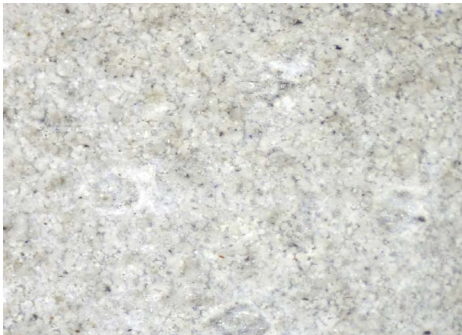
Рисунок 23 – Макроструктура поверхности образцов с покрытием от 75 до 80 мкм
