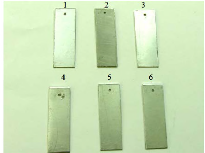
Образцы из алюминия марки А7 для отработки режимов МДО
