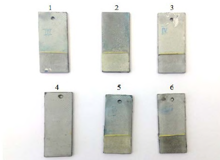
Рисунок 27 – Образцы после испытаний. 1 и 2 образец с покрытием от 50 до 60 мкм; 3 и 4 образец с покрытием от 75 до 80 мкм; 5 и 6 образец с покрытием от 90 до 100 мкм
