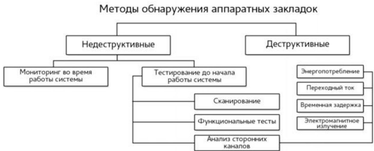
Рисунок 2.5 Общая классификация методов обнаружения аппаратных закладок
