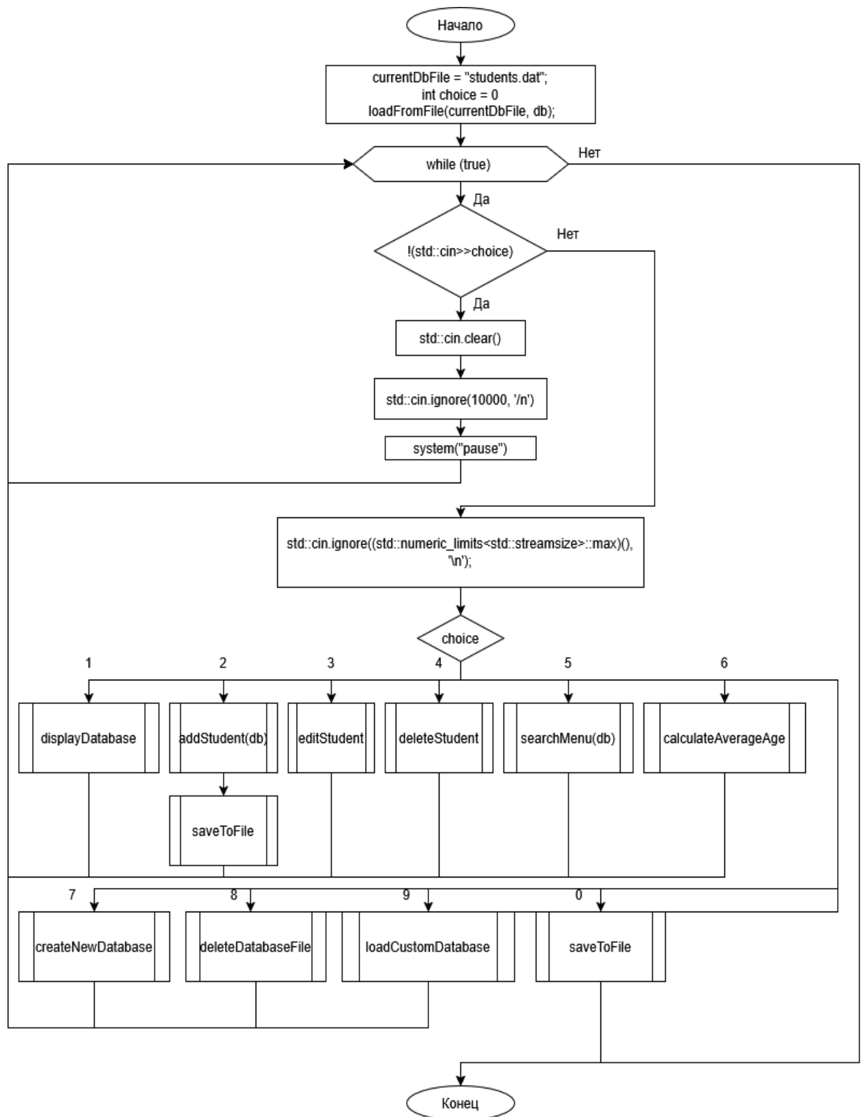
Рисунок 2.1 - Блок-схема функции main
