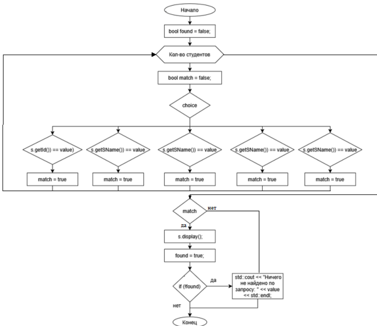
Рисунок 2.11 - Блок-схема функции findStudents
