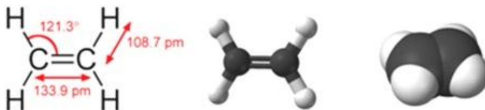
Рисунок 19. Структурная формула молекулы этилена
