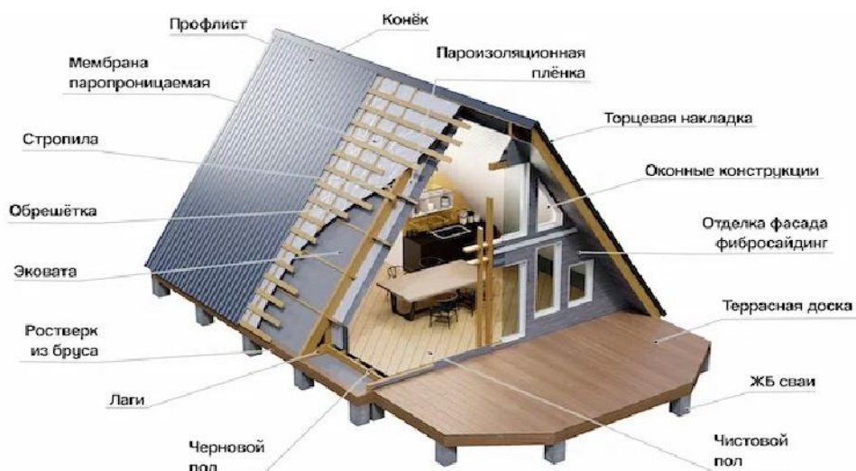
Рисунок 23 – Строительные материалы, используемые при строительстве дома А-фрейм
