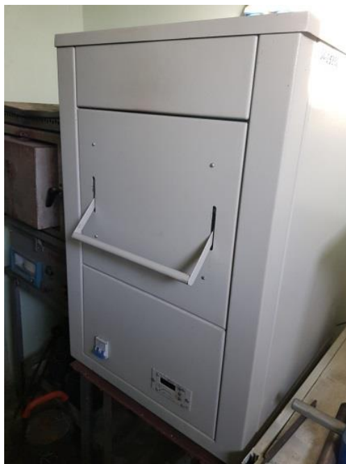
Рисунок 17 – Электродуховка СНОЛ 12/16 с регулятором температуры модель ПТ 200
