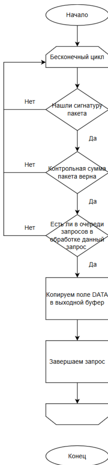
Рисунок 20 – Схема алгоритма получения входящих пакетов
