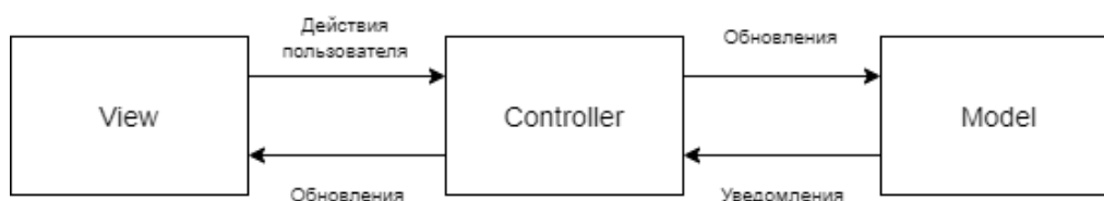
Рисунок 25 – Схема шаблона MVC
