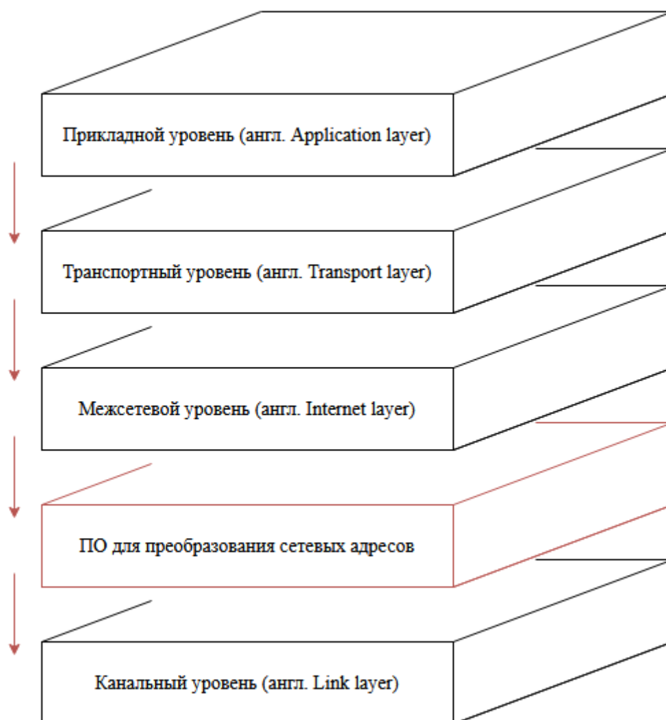
Рисунок 13 - Схема отправки пакета по модели TCP/IP после включения в неё NAT
