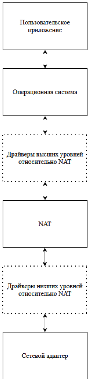
Рисунок 14 – Условная схема взаимодействия ОС и сетевого адаптера после установки NAT
