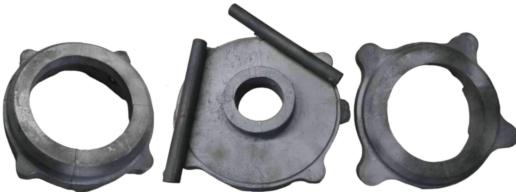
Рисунок 11 – Отливки после обрезки литниково-питающей системы
