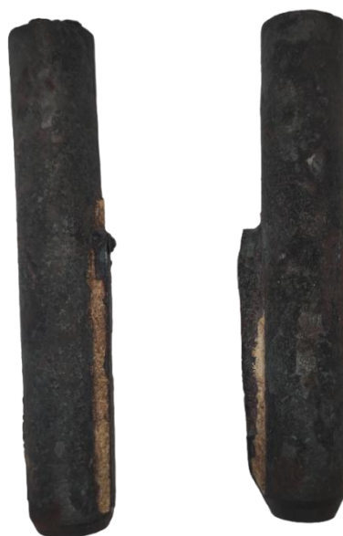
Рисунок 29 – Литые заготовки под образцы для механических испытаний на разрыв
