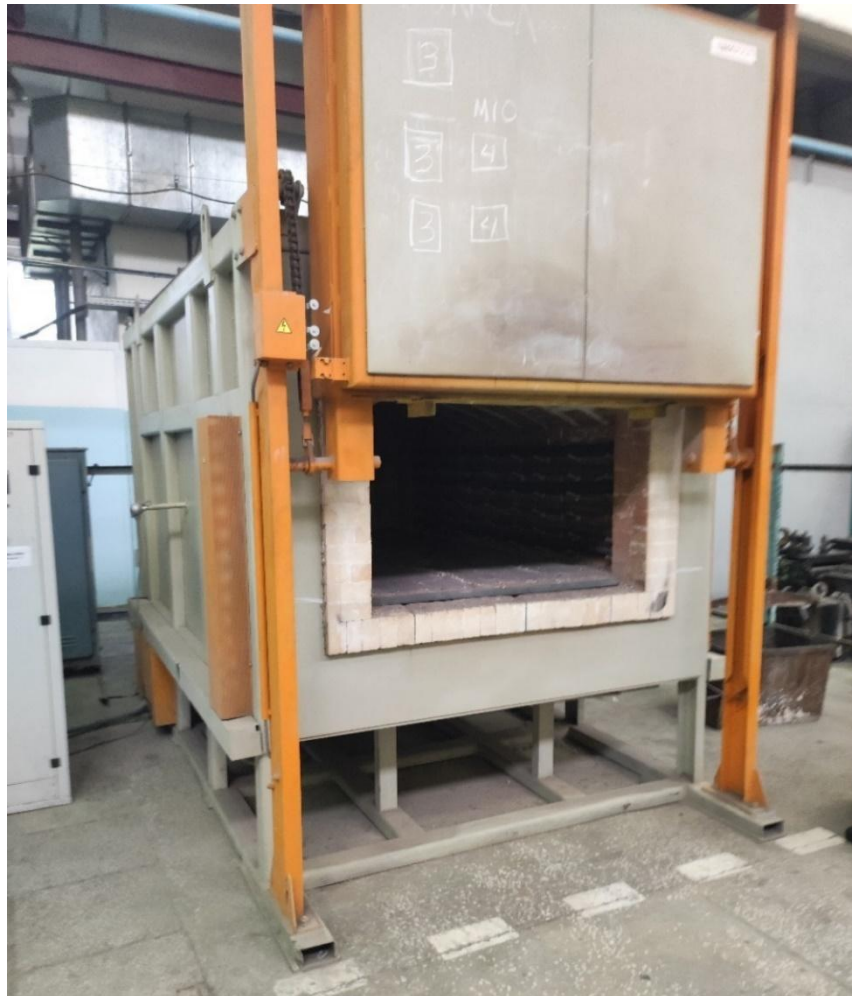
Рисунок 8 – Печь камерного типа ПКМ 12.22.7/11М
