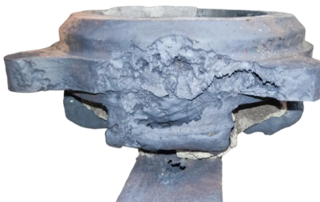
Рисунок 22 – Крупная газовая раковина на поверхности отливки
