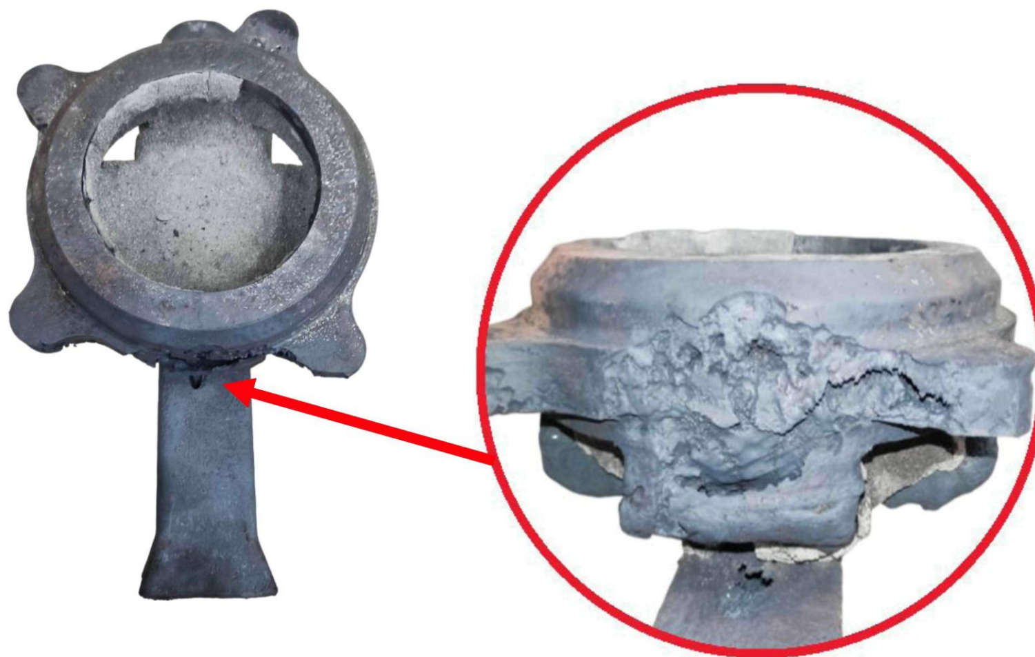
Рисунок 9 – Крупная газовая раковина на поверхности отливки
