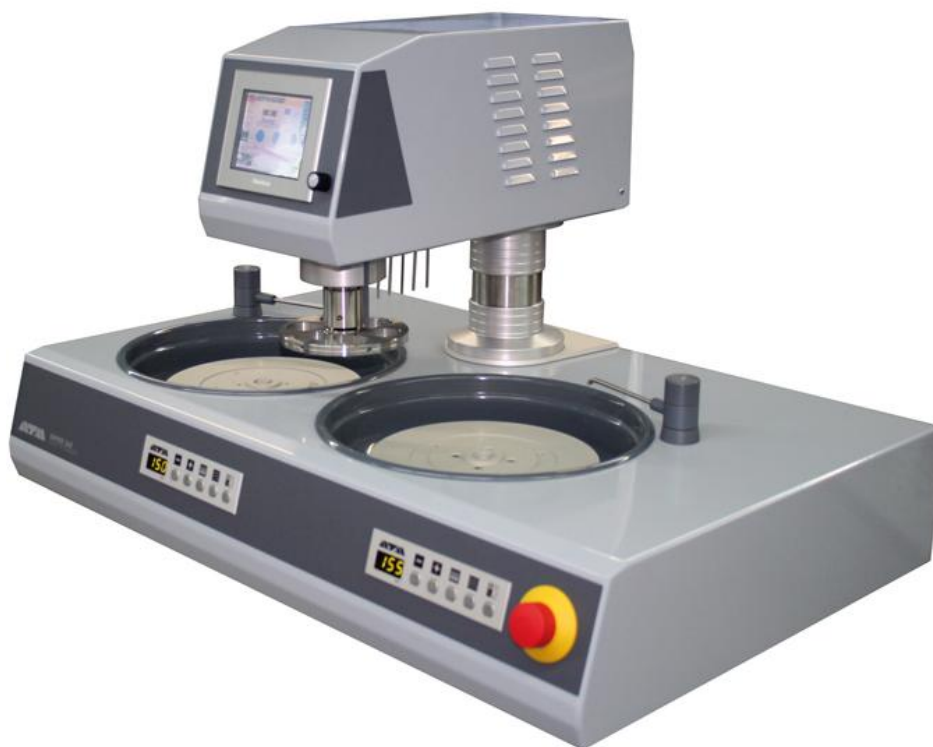
Рисунок 2 – Шлифовально-полировальный станок Saphir 560
