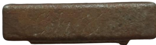
Рисунок 27 – Литая заготовка под образец для химического анализа
