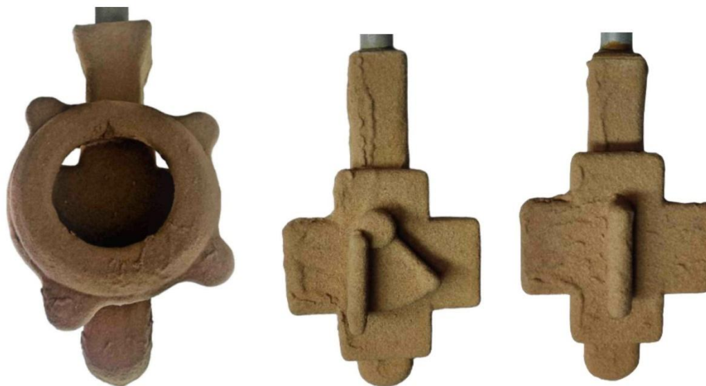
Рисунок 5 – Керамические формы перед выплавкой модельного состава
