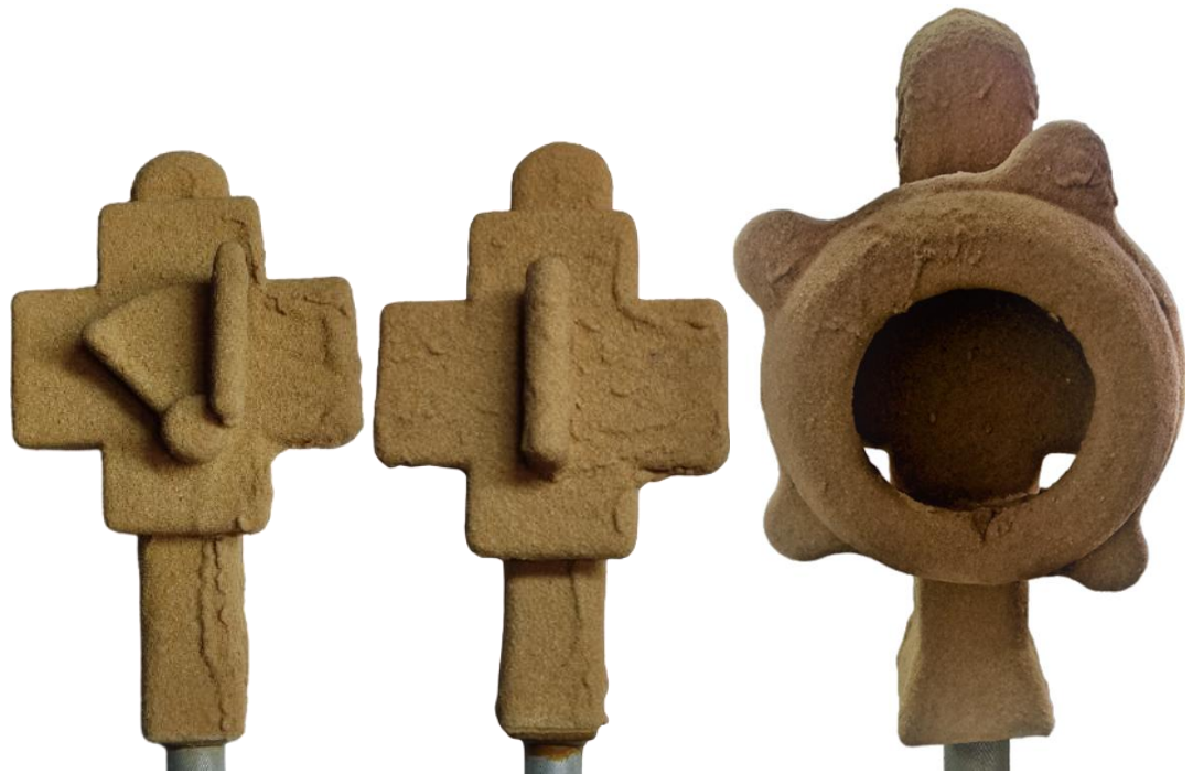
Рисунок 17 – Керамическая форма перед выплавкой модельного состава
