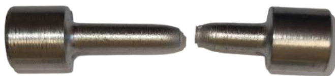
Рисунок 33 – Образец после механических испытаний на разрыв
