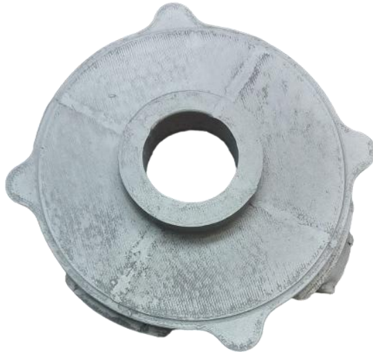
Рисунок 26 – Отливка после зачистки
