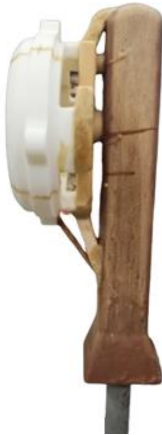
Рисунок 24 – Модель ЛПС дополнена воздушными каналами и выпорами
