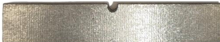
Рисунок 31 – Образец для механических испытаний на ударную вязкость с U-образным концентратором напряжения
