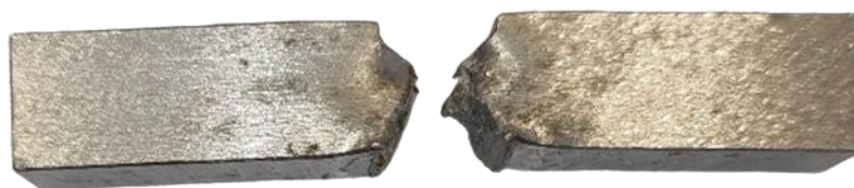
Рисунок 32 – Образец после механических испытаний на ударную вязкость
