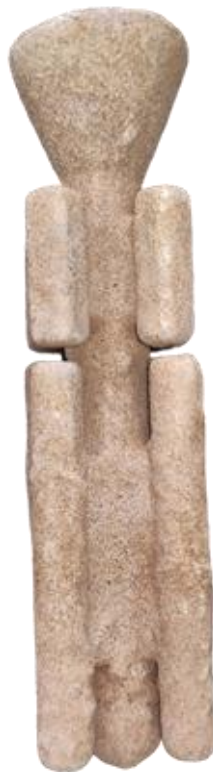
Рисунок 21 – Керамическая форма под образцы для определения химического состава и механических свойств
