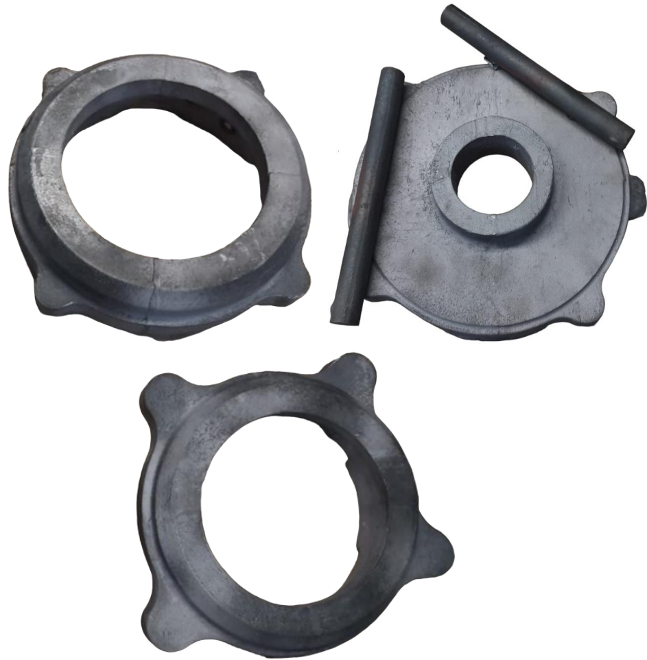
Рисунок 25 – Отливки после обрезки ЛПС
