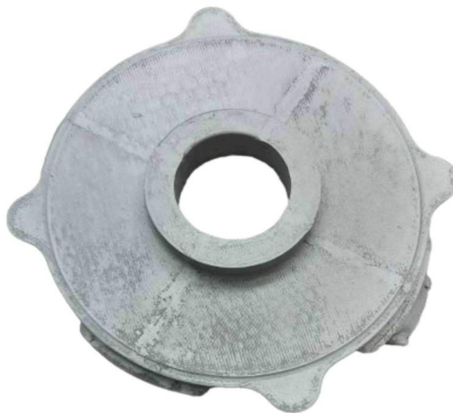
Рисунок 12 – Отливка после зачистки
