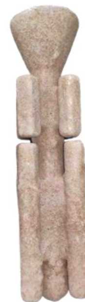
Рисунок 8 – Керамическая форма под образцы для определения химического состава и механических свойств после выжигания моделей и прокали
