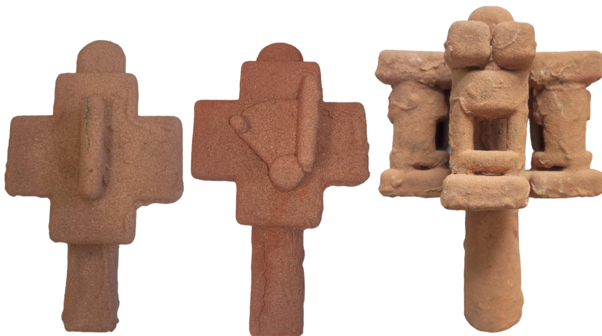
Рисунок 18 – Керамические формы после прокалки
