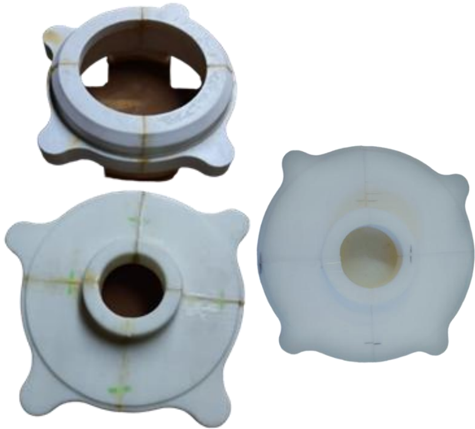
Рисунок 12 – Склеенные полимерные модели
