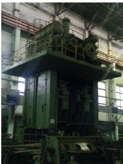
Рисунок 8 – Гидравлический пресс Erfurt PKnVT VI 800 FS
