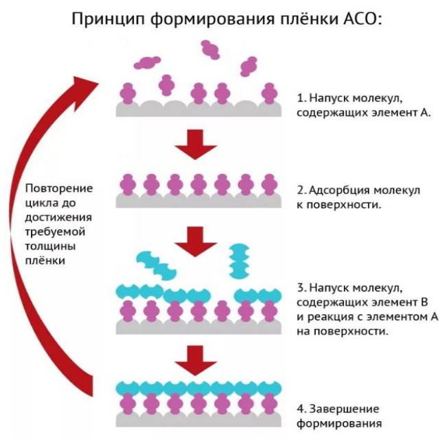
Рисунок 1.2 - Принцип формирования пленки через атомно-слоевое осаждение.
